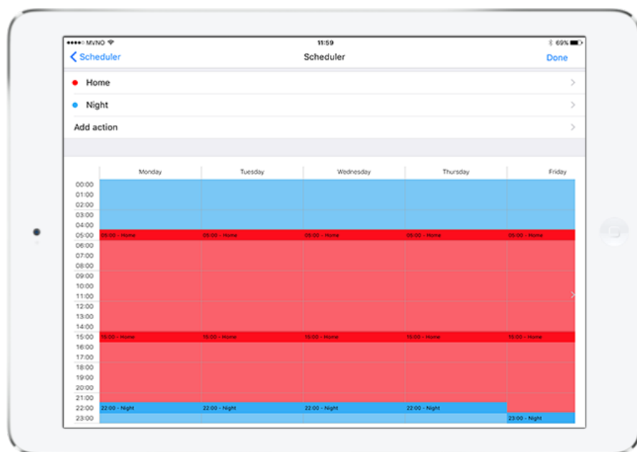
Image 8 : Configuration d'un programmeur
